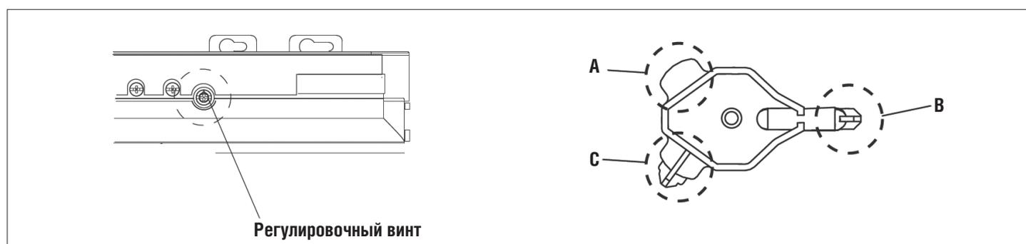
Используйте инструмент регулировки (A), чтобы изменить угол глубины области. Высота монтажа — 2,5 м.
