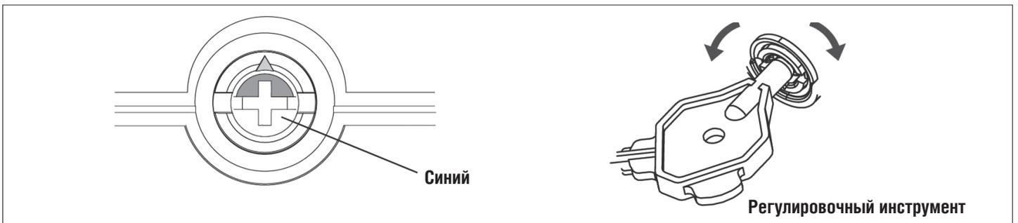
Используйте инструмент регулировки (В) для изменения угла глубины области.
